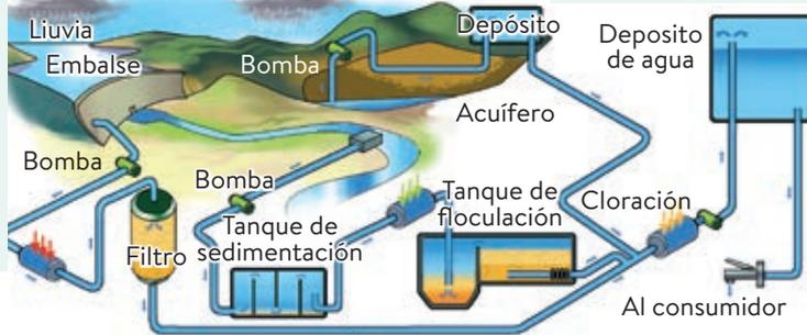
4. Después se lleva a cabo la **desinfección** del agua con radiación ultravioleta o cloro, y se almacena en depósitos para ser distribuida.
