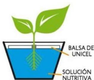
Este método, las plantas se encuentran en una lámina o balsa de unicel que flota sobre la solución nutritiva, de modo que sus raíces están sumergidas dentro de la solución. Una bomba de aire le proporciona a las raíces el oxígeno necesario para su óptimo desarrollo.
